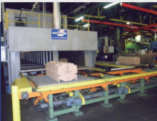
**Secador tipo túnel para machos de areia para fundição.
